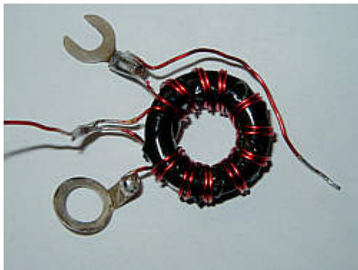
Балун после намотки. 11 катушек с проволокой 0,9 мм в эмали на сердечнике F2001.
