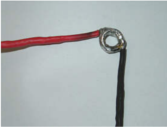
Дельта угол из 2 мм медной проволоки. Кабель припаян к нему.
